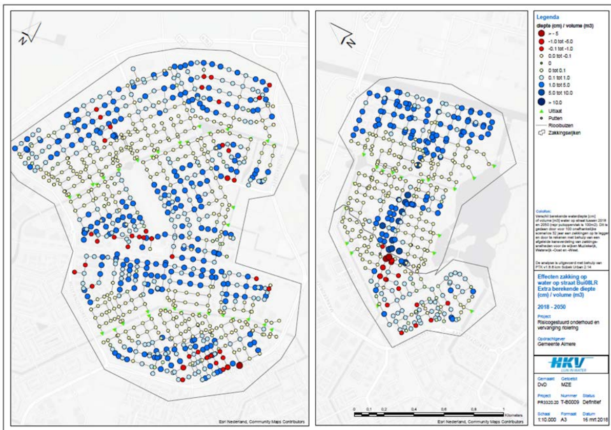
Figuur 4.2 Maximale water op straat situatie ([cm] / volume [ m^3 ]) bij bui 08 in 2050 als gevolg van 32 jaar ongelijkmatige zetting op basis van het gemiddelde van alle simulaties voor 2050.
