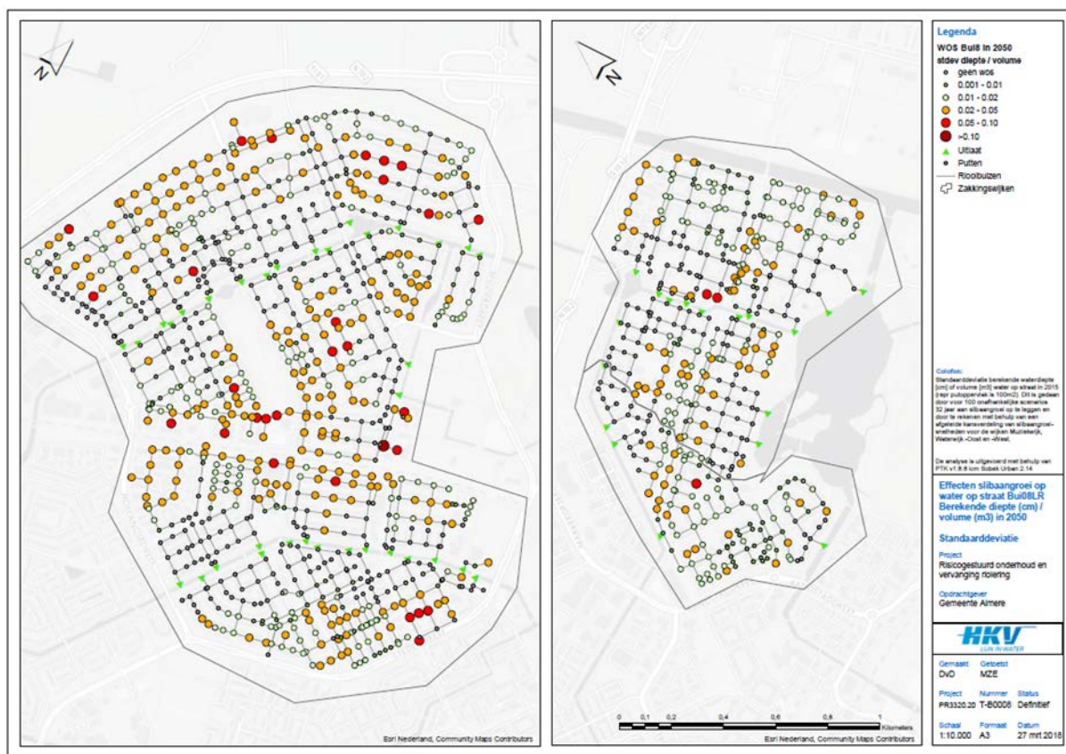
Figuur G.2 Spreiding (standaarddeviatie) in uitkomsten van het maximaal berekend water op straat bij Bui 08 bij max 8 jaar slibophoping voor alle simulaties
