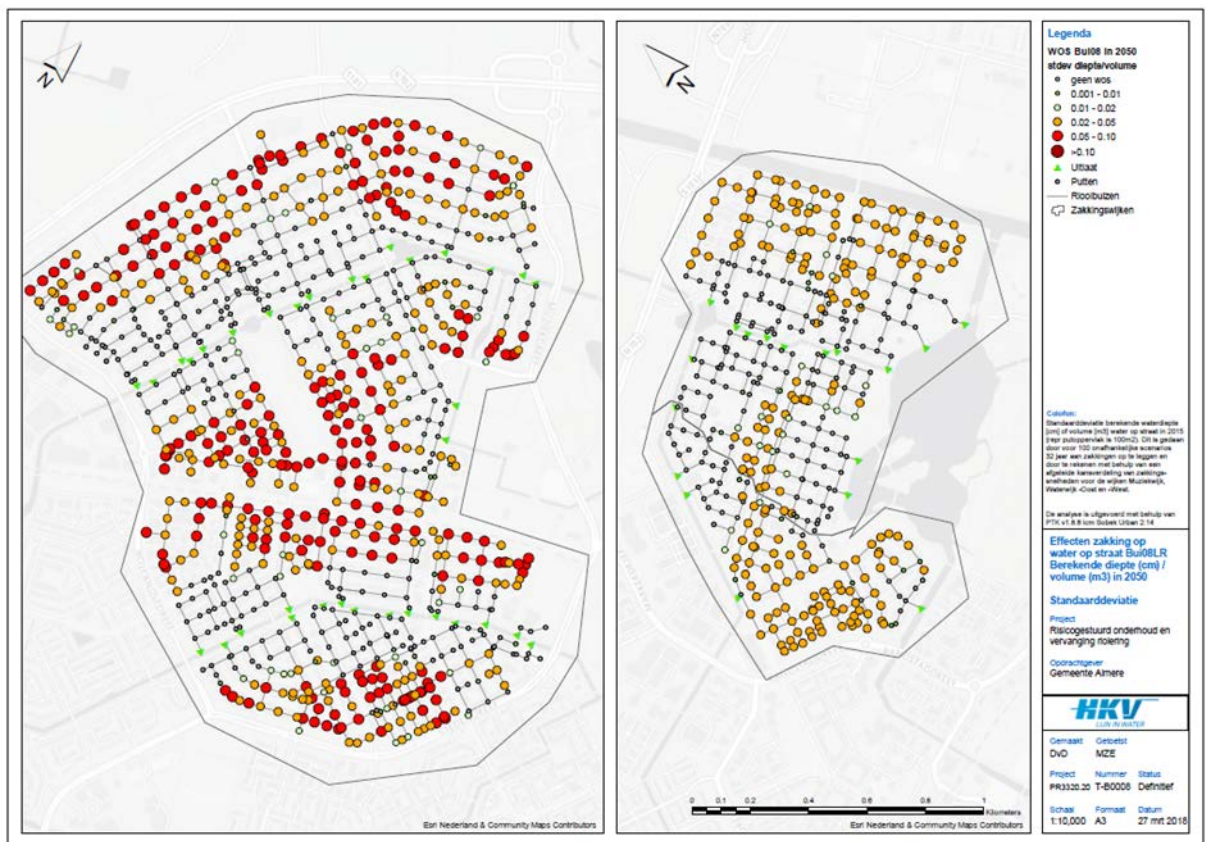
Figuur 4.3 Standaarddeviatie van de maximaal berekende extra water op straat bij Bui 08 in 2050 voor alle simulaties als gevolg van 32 jaar ongelijke zetting.
