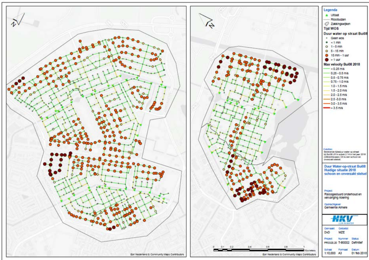
Figuur D.2 Water op straat (duur) en maximale stroomsnelheid in buizen (m/s) – Bui 08 huidige situatie 2018
