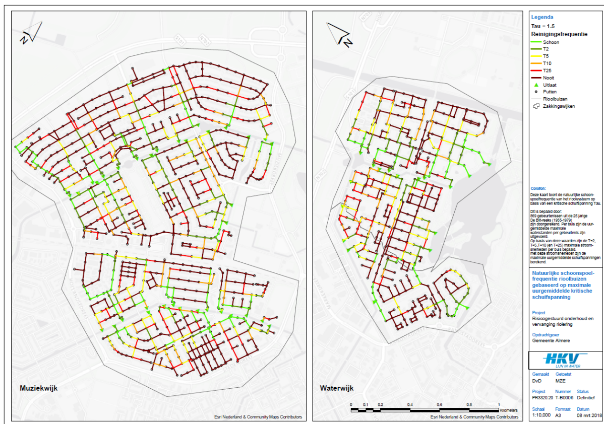
Figuur 7.3 herhalingsijd schoonspelen rioolstrengen volgens de methode van steekproefkwantelen met de 25jarige De Bilt reeks bij een kritische schuifspanning van 1,5N/m^2
