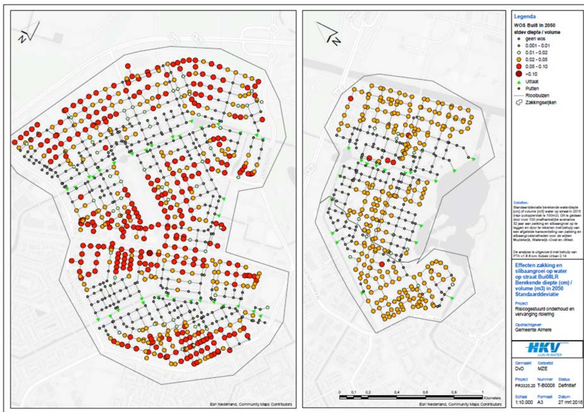
Figuur H.2 van de maximaal berekende extra water op straat bij Bui 08 in 2050 (met een onderhoudsfrequentie van 8 jaar) ten opzicht van een schoon stelsel in 2018 van alle simulaties.
