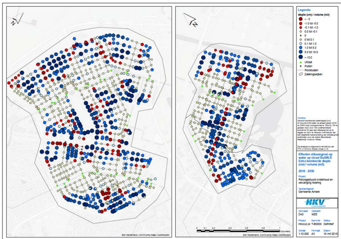
Figuur G.1 Maximale water op straat situatie ([cm] / volume [m 3 ]) bij bui 08 in 2050 als gevolg van maximaal 8 jaar slibophoping op basis van het gemiddelde van alle simulaties voor 2050.
