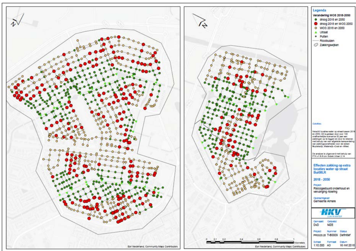
Figuur 4.4 Verschil in water op straat locaties bij bui 08 in 2050 ten opzichte van 2018 als gevolg van 32 jaar ongelijke zetting op basis van het gemiddelde van alle simulaties voor 2050
