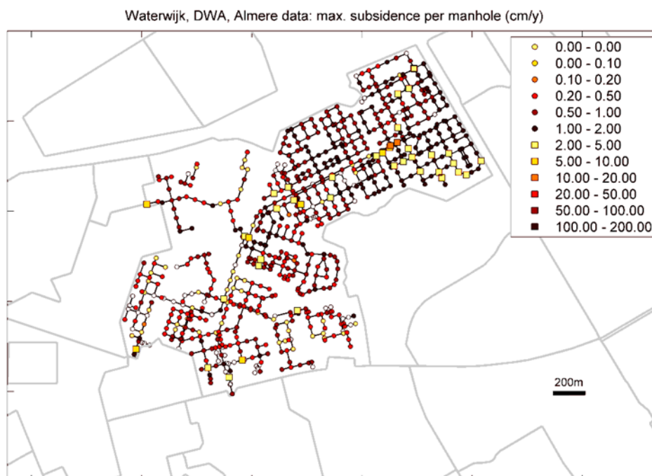
Figuur 3.6 Maximale zetting per putdeksel in Muziekwijk voor de jaren 1998-2017 (zettingen > 10 cm/jaar zijn niet meegenomen in de analyse)
