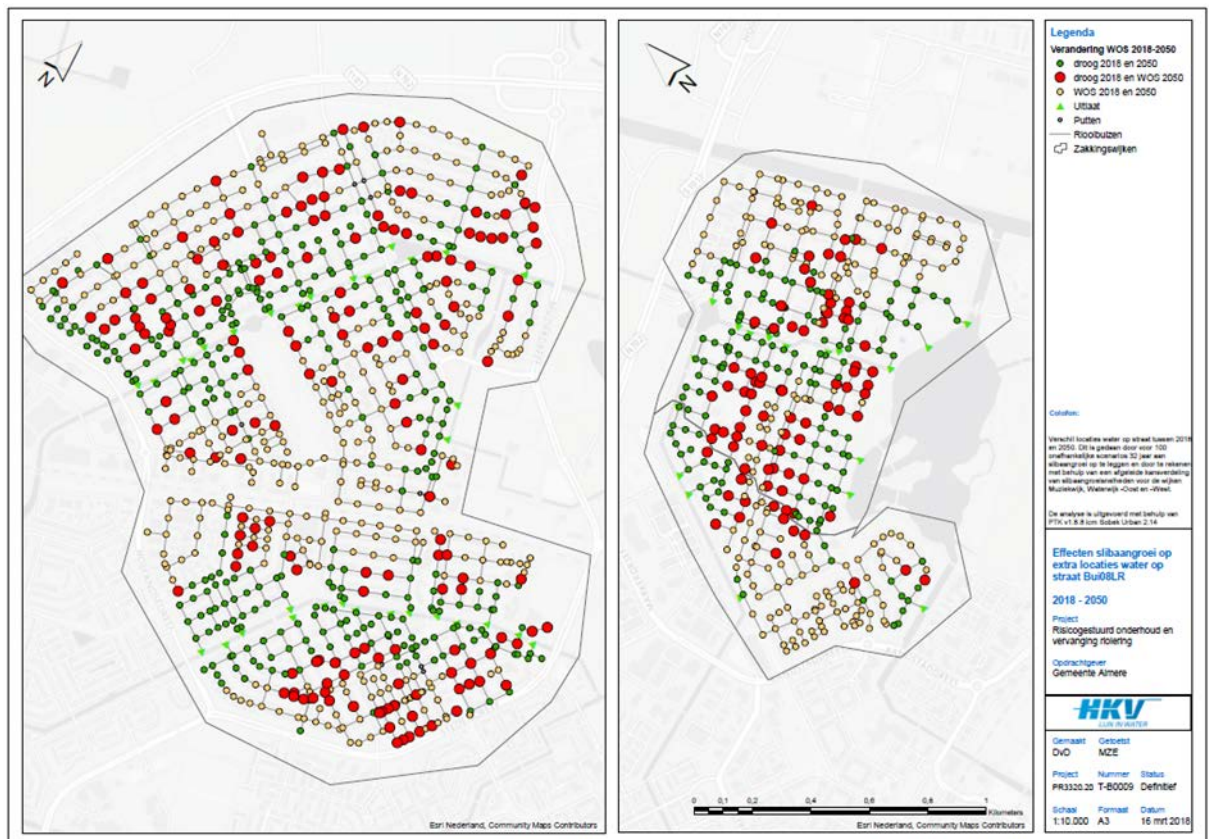
Figuur G.3 Gemiddelde van de maximaal berekende extra locaties water op straat (rode bollen) bij Bui 08 bij maximaal 8 jaar vuilophoping voor alle simulaties
