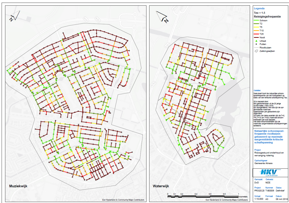
Figuur C.2 Natuurlijke reinigingsfrequentie buizen volgens de methode van steekproefkwantielen met de 25jarige De Bilt reeks bij een kritische schuifspanning van 1,5N/m 2
