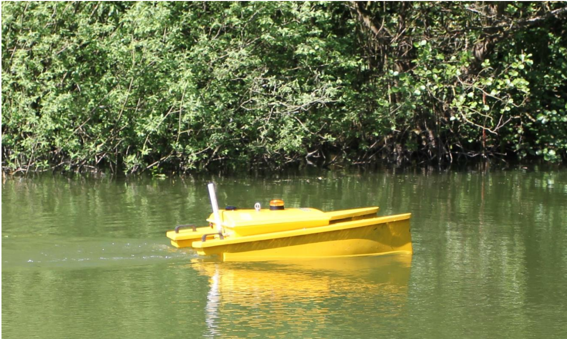
Afbeelding 8.1 Voorbeeld meetbootje voor kleine watergangen
