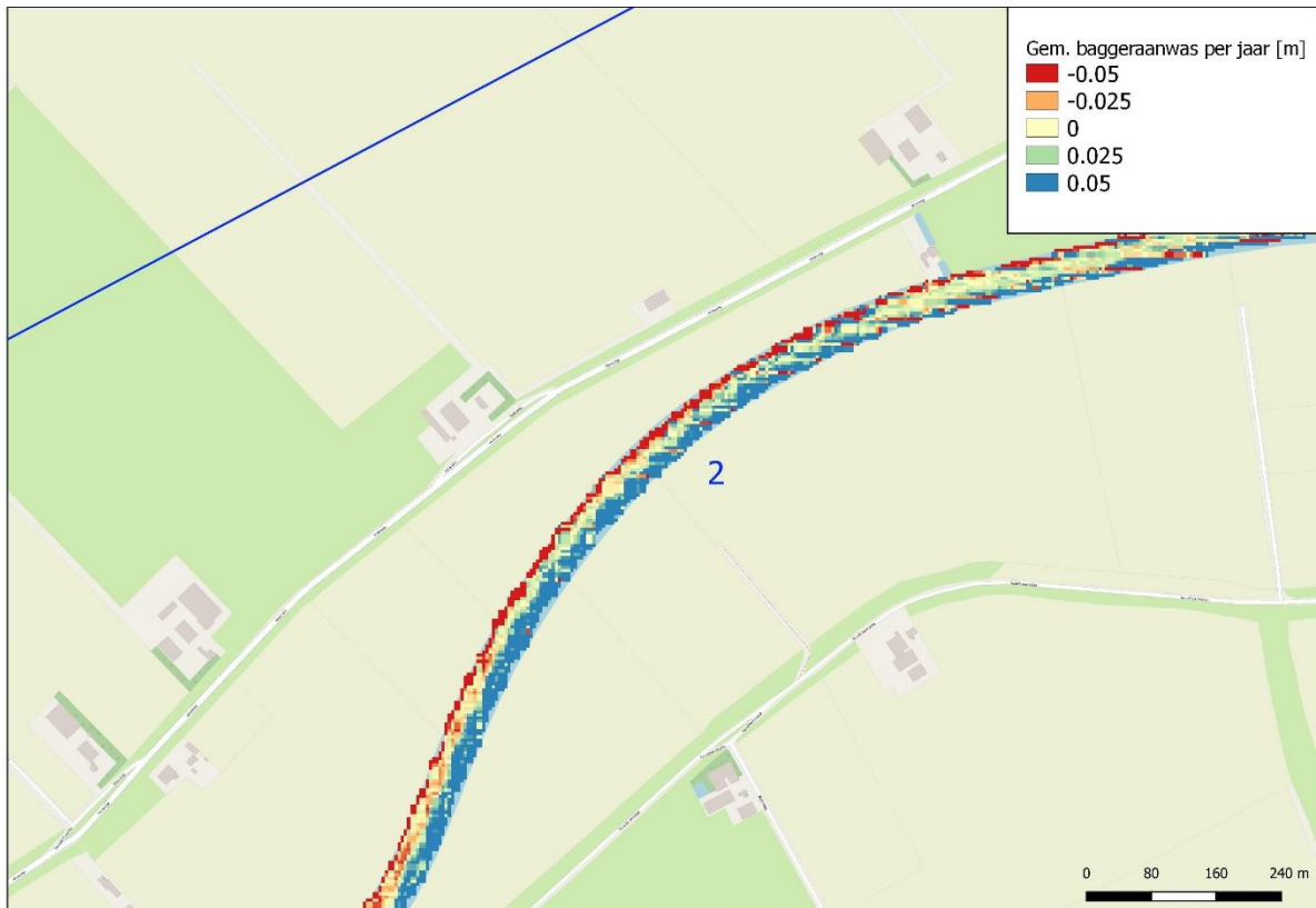
Figuur 29: ruimtelijk variatie in baggeraanwas als gevolg van erosie en sedimentatie in bochten
